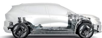
**Die AmpR-Medium-Plattform** bildet die Technikbasis für den Scenic E-Tech Electric. Sie wurde speziell für rein batterieelektrische Fahrzeuge konzipiert und zeichnet sich durch einen kompakt geschnittenen Motorraum, weit außen positionierte Räder und einen großzügigen Radstand aus. Zusätzlich ermöglicht sie den Einbau einer schlanken Antriebsbatterie.
