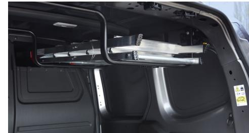
**„EASY INSIDE RACK“** ist eine einklappbare Innendachgalerie, die es ermöglicht, lange Gegenstände, wie etwa Leitern oder Rohre, unter dem Fahrzeugdach zu transportieren. Vorteile: Der Beifahrersitz muss hierfür nicht geräumt werden, und der Laderaumboden bleibt frei für zusätzliches Transportgut.
