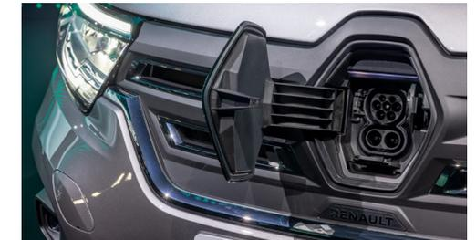
**DAS COMBINED-CHARGING-SYSTEM** des Kangoo Rapid E-Tech Electric erlaubt je nach Version das beschleunigte Laden mit Wechselstrom bis 22 kW Ladeleistung und das Schnellladen mit Gleichstrom bis 80 kWh.
