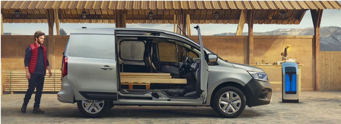
**MIT „OPEN SESAME BY RENAULT“** ist für den Kangoo Rapid E-Tech Electric die breiteste seitliche Ladeöffnung der Kompaktlieferwagenklasse verfügbar. Durch die Integration der B-Säule in die Schiebetür und Beifahrertür auf der rechten Wagenseite entsteht ein 1,46 Meter breiter Zugang zum Laderaum.
