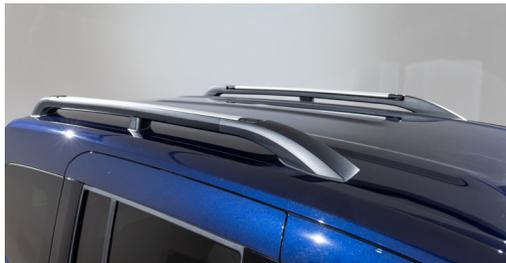
**DIE INNOVATIVE DACHRELING** des Kangoo E-Tech Electric lässt sich in nur wenigen Handgriffen und ohne Werkzeug in einen Gepäckträger mit 80 Kilogramm Traglast verwandeln.
