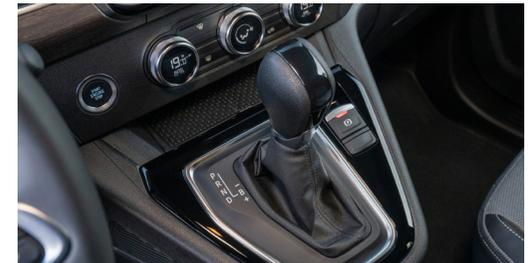
**DIE REKUPERATIVE BREMSSTRATEGIE** steigert die Effizienz des Kangoo E-Tech Electric. Dabei wirkt der Elektromotor wie ein Generator, der Strom in den Akku einspeist. Die konsequente Nutzung der Rekuperation bringt deshalb Reichweitevorteile. Am Wählhebel ist die Wahl zwischen drei Rekuperationsstufen möglich.
