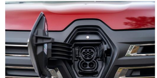
**DAS COMBINED-CHARGING-SYSTEM** des Kangoo E-Tech Electric erlaubt das beschleunigte Laden mit bis zu 22 kW Wechselstrom und das Schnellladen mit bis zu 80 kW Gleichstrom.
