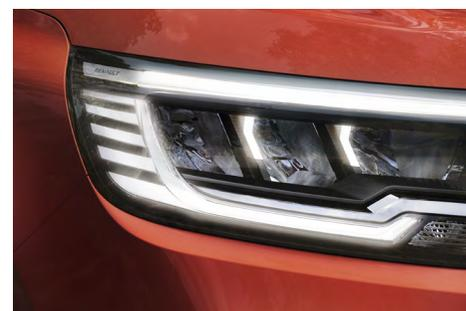
**VOLL-LED-SCHEINWERFER** zählen im Kangoo zur Serienausstattung. Die Leuchtweite steigt hierdurch im Vergleich zu konventionellen Halogenscheinwerfern um 130 Meter, und der Lichtkegel ist 37 Meter breiter.
