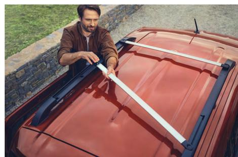
**DIE INNOVATIVE DACHREILING** des Kangoo lässt sich mit wenigen Handgriffen in einen Dachgepäckträger mit 80 Kilogramm Traglast verwandeln. Hierzu werden einfach zwei an den entgegengesetzten Enden mit einem Gelenk versehenen Segmente quer über das Dach geschwenkt und arretiert.
